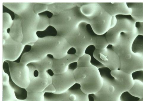
Abbildung 2: Mikroporosität im Detail, Porengröße bis ca.  $5 \mu\text{m}$ ; Sinterhälse sind erkennbar.
